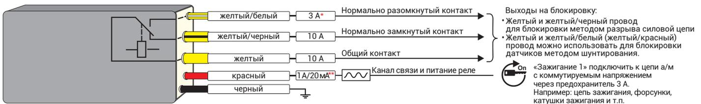
\* Максимальный ток через нормально разомкнутый контакт ограничен сечением (0,35 мм<sup>2</sup>) провода.
